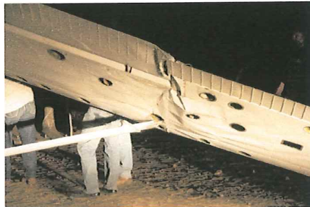
SE QUEBRO EL SPAR CENTRAL DEL ALA DERECHA.
