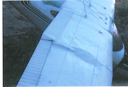
SE QUEBRO EL SPAR CENTRAL DEL ALA DERECHA.
